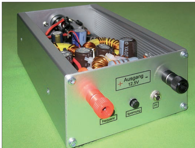
Bild 1: Betriebsbereites geöffnetes Gerät; unterhalb der kräftigen Anschlussbuchsen sind die Steller für Frequenz (f) und Spannung zu erkennen.
