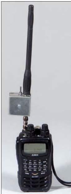
Bild 4: Aufgrund seiner geringen Masse bringt der aufgeschraubte Vorverstärker das Handfunkgerät nicht aus dem Gleichgewicht. Der kleine Verstärker ermöglicht mit der Antenne EA-163 sehr guten Empfang auf MW und benachbarten Frequenzen.
