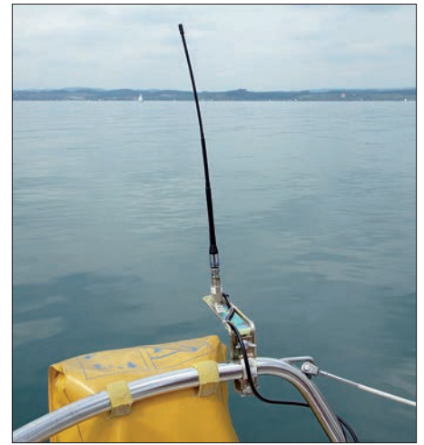
Bild 2: Auf einer Segelyacht [4] ist eine separate UKW-Antenne (handelsübliche Aufsteckantenne) hinten an der Reling gut untergebracht, sofern man keinen Zugang zur Mastspitze hat.
