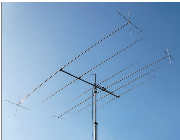
Bild 1: 3-Band-Yagi LZA-6-3 komplett aufgebaut; man erkennt die elektrische Verlängerung durch Dachkapazitäten bei den 20-m-Elementen.
