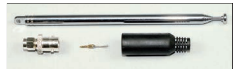
Bild 3: Die Teleskopantenne wird mit dem Innenleiter eines BNC-Steckers und der Hülle eines Mini-DIN-Steckers an einen BNC-auf-SMA-Adapter montiert und kann so auf die Antennenbuchse des Alinco DJ-G7E geschraubt werden.
