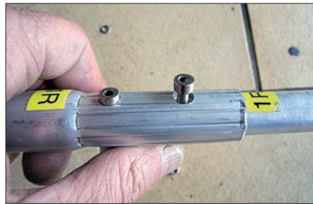
Bild 10: Gepresste Elementenden der dickeren Innenelementrohre; die Folgerohre werden mit zwei Zylinderkopfschrauben befestigt.
