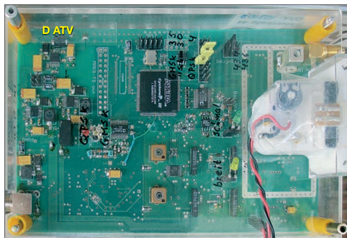
Ein Prototyp des GMSK/QPSK-Monoboards für 70 cm nach DJ8DW (Platinenoberseite); zu erwähnen ist u. a. der verwendete FPGA, ein Altera EP3C25. Fotos: DM2CMB
