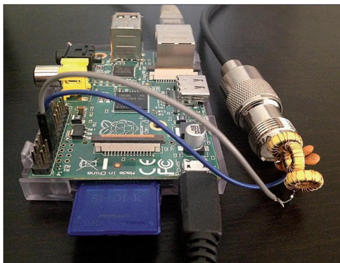
Bild 1: Minimalvariante des Raspberry Pi als WSPR-Bake auf dem 30-m-Band mit dem unbedingt nachzuschaltenden, hier in „fliegender“ Verdrahtung ausgeführten Tiefpassfilter
