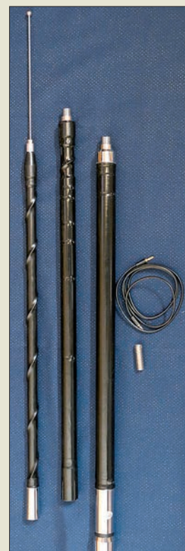
Dreigeteilte HFMB01 mit der Wanderleitung zum Bandwechsel
