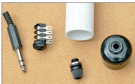
Bild 5: Schutzrohr und Endkappe mit eingebauter Klinkenbuchse (rechts); alternativ kann das Anschlusskabel ohne Steckverbindung über eine Kabeldurchführung mit Zugentlastung (Mitte) aus dem Schutzrohr herausgeführt werden.
