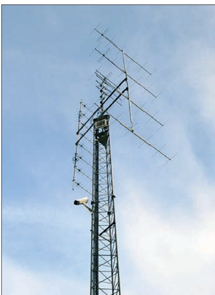
Die vier vertikal gestockten 8-Element-Yagi-Antennen bei SK7MW ergeben eine für Conteste und Tropo-DX fast ideale Abstrahlung: Einerseits ein vergleichsweise „breiter“ horizontaler Öffnungswinkel, sodass ein recht großer Sektor befunkt wird. Andererseits sorgt die durch Stockung recht schmale vertikale Bündelung für optimale Reflexionsverhältnisse an Grenzschichten, wie sie bei troposphärischen Überreichweiten vorkommen.
