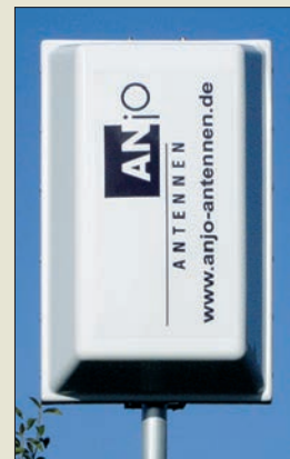
Montage der im Radom untergebrachten Richtantenne bei horizontaler Polarisation
